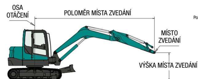
Poznámka: 1. Hodnota s \* je omezeno výkonem hydraulické soustavy a vychází z ISO 10567. Jmenovitá nosnost nepřesahuje 87 % výkonu hydraulické soustavy.
