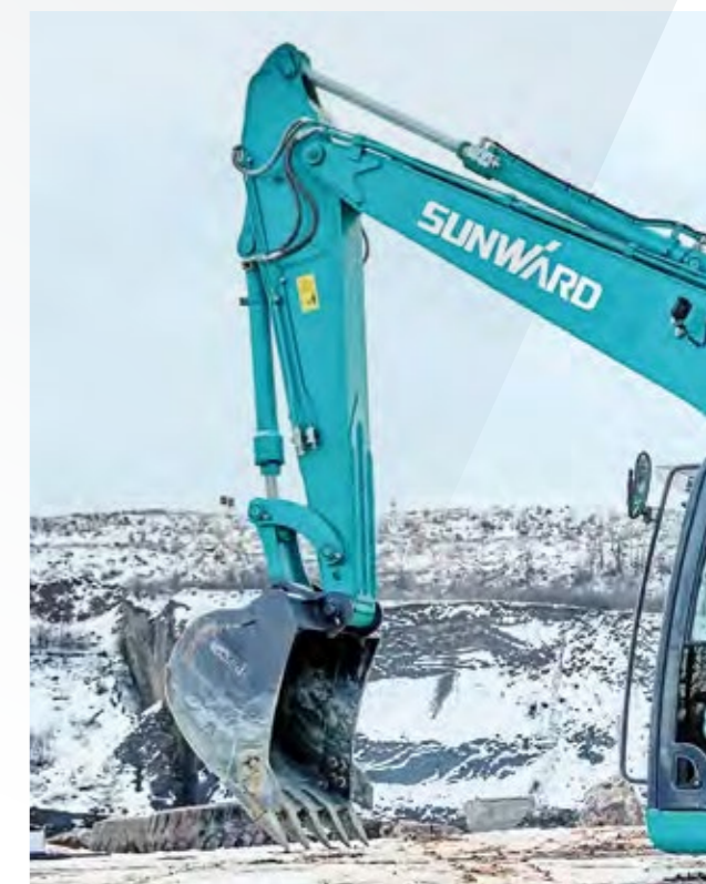
■ Výkvná násada a pákové lopaty jsou navrženy na standard provozní spolehlivosti 20 000 hodin
